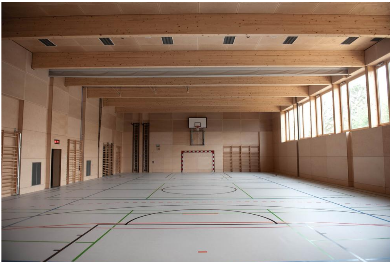
Insgesamt wurden 4.300 m 2 CLT-Massivholzdecken und 3.100 m 2 CLT-Massivholzwände verbaut. Quelle: Gerfried Tamerler/PORR
