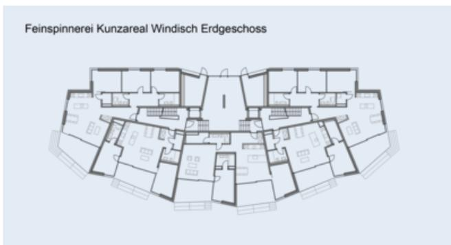
Der Grundriss des Erdgeschosses. Er unterscheidet sich von den darüberliegenden Geschossen. Quelle: PORR
