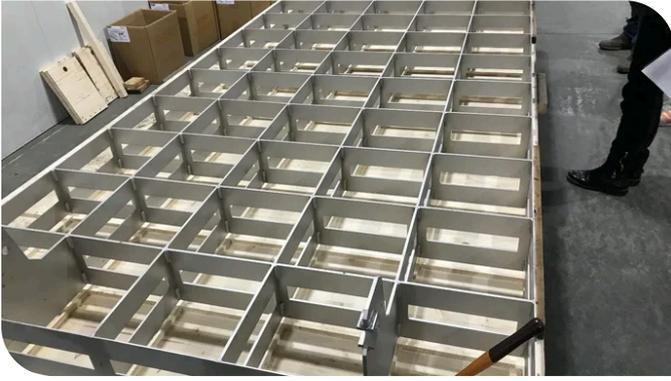
Die Gussglas-Elemente wurden im Werk in Edelstahlgrids montiert. Quelle: PORR
