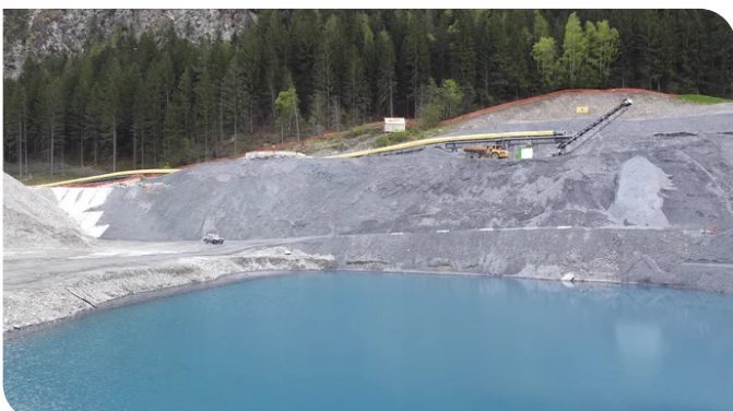
In einer so genannten Seitenentnahme werden Zuschlagstoffe gewonnen und vor Ort aufbereitet. Quelle: ARGE GKI Maria Stein
