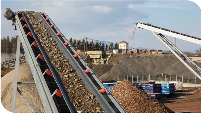
Die Förderbänder mit Mittelfraktion und dem Endprodukt. Quelle: Daniel Ulbricht-Sundt
