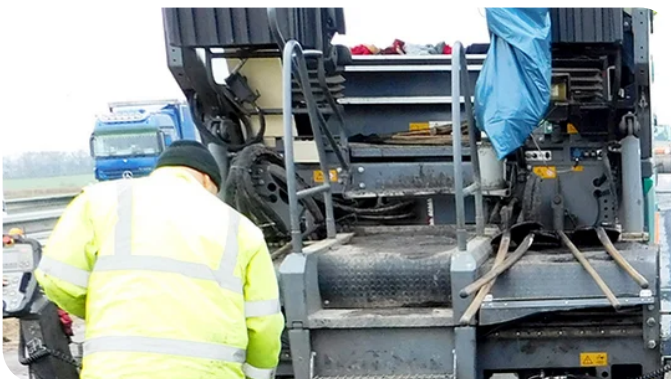
RB 500 Resonanzbrecher – Baumaschine zum Abreißen des Betonunterbaus. Bild: PORR AG
