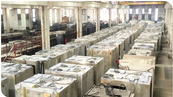
Produktion der Fertigbadzellen aus Stahlbeton. Bild: PORR AG
